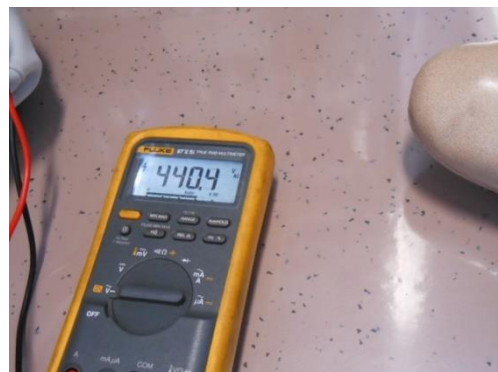
圖 1-79 SIV1 三相電壓 440Vac 量測
