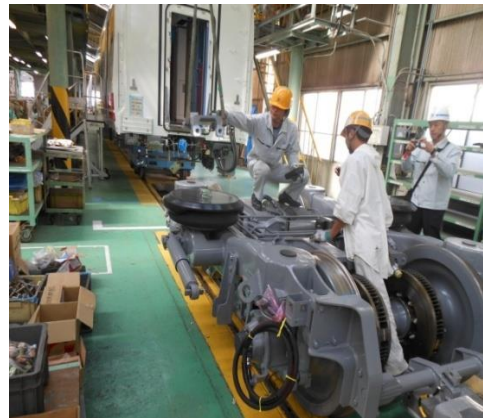
圖 1-2 工廠普悠瑪生產線
