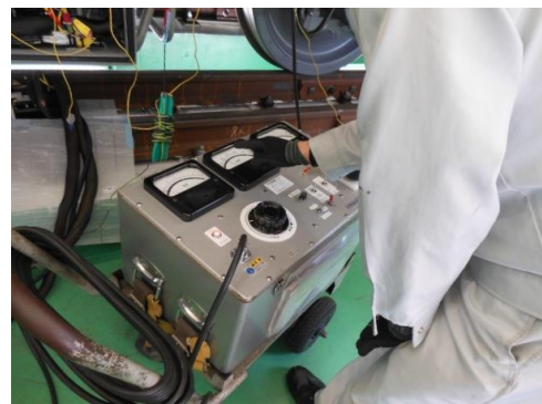
圖 1-30 TEP2035 高壓耐壓測試
