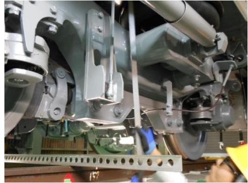
圖 1-55 TEMB 後端 bogie2 高度量測
