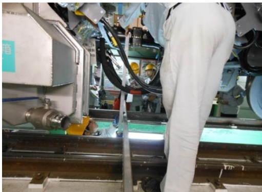
圖 1-62 TEMB2072 前端連結器高度量測
