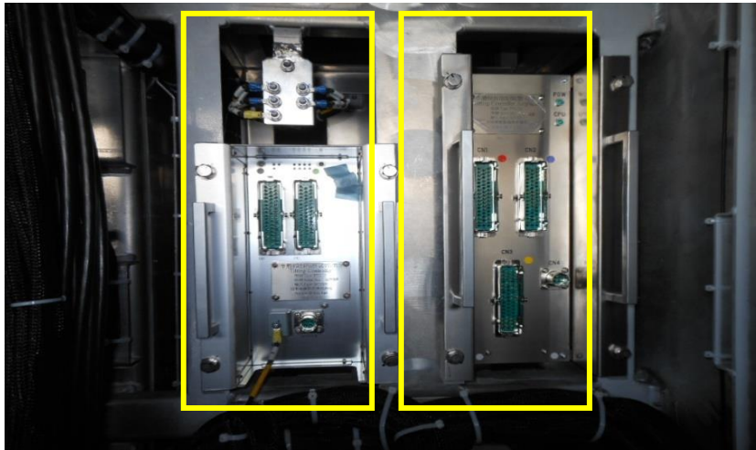
圖 2-7 左為 TC 控制裝置(TTC-12)，右為 AMP 增幅放大器(Tilting Controller Amplifier；TTA-12)
