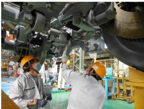
圖 1-5 轉向架阻尼安裝作業
