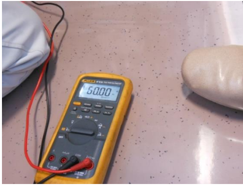
圖 1-80 SIV 三相電壓頻率 60Hz 量測
