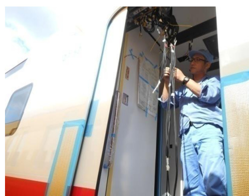
圖 1-16 上下車門門機控制配線
