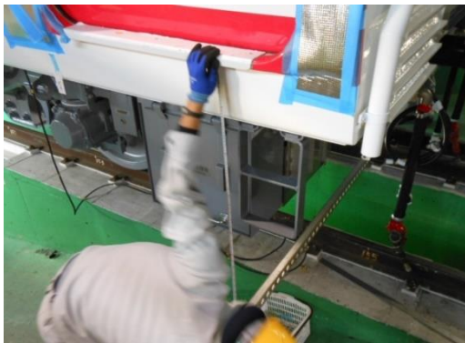
圖 1-64 TEMB2072 後端車門高度量測
