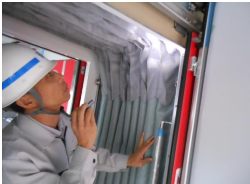
圖 1-88 風檔雨漏檢視
