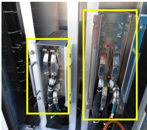
圖 2-8 左為 MC 控制裝置(TMC-12)， 右為 AMP 增幅放大器(TTA-12； Tilting Controller Amplifier)
