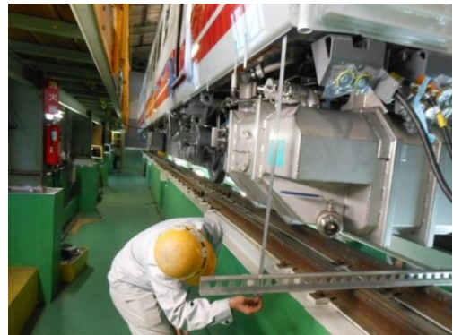
圖 1-57 TEMB 前端車身高度量測
