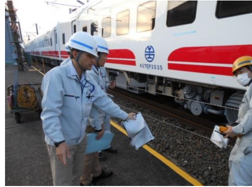
圖 1-75 涼油器鼓風機風量測試
