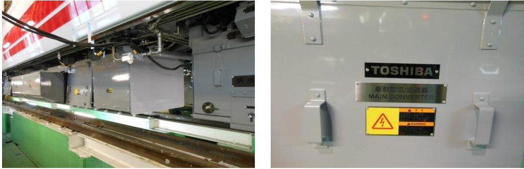
圖 3-3 牽引整流器(converter)/變流器(inverter)外觀及箱蓋銘版
