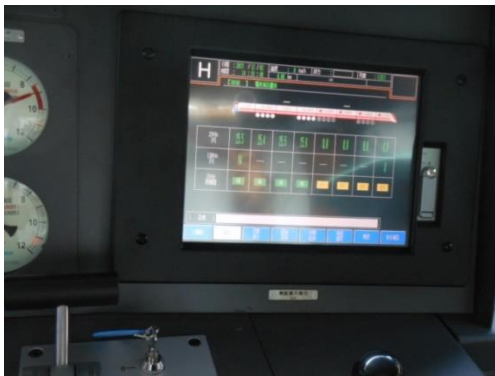
圖 1-82 TEMU2035 電瓶電壓檢視
