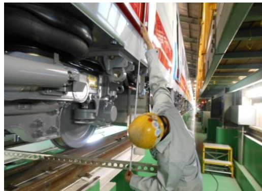
圖 1-65 TEMB2072 前端車門高度量測
