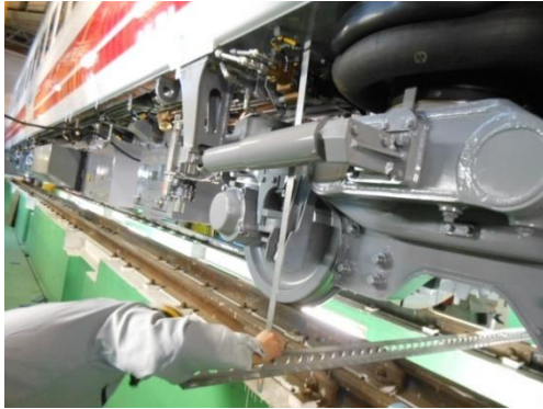
圖 1-54 TEMB 前端 bogie1 高度量測
