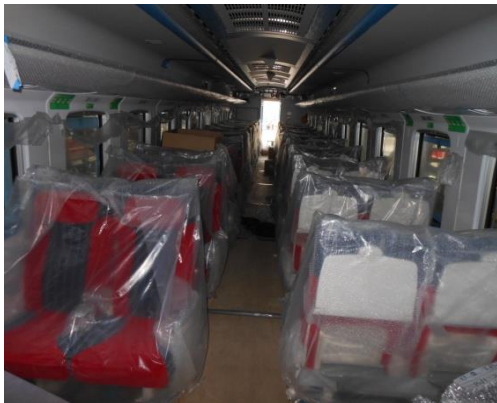
圖 1-9 座椅安裝檢視
