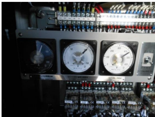
圖 1-76 電瓶充電電壓/電流與 SIV 電壓
