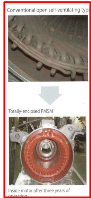
附圖 2-3 PMSM 內部組件與結構
