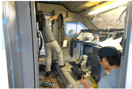
圖 1-18 駕駛室停留軌機控制接線
