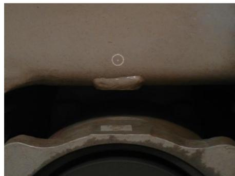
圖 5-34 軸箱高度量測基準點
