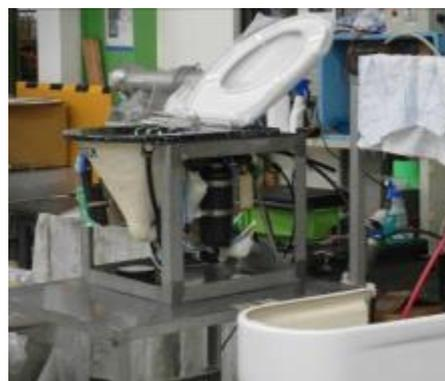
圖 3-36 真空式廁所功能測試
