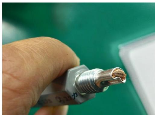
圖 3-20 接觸片壓接斷面
