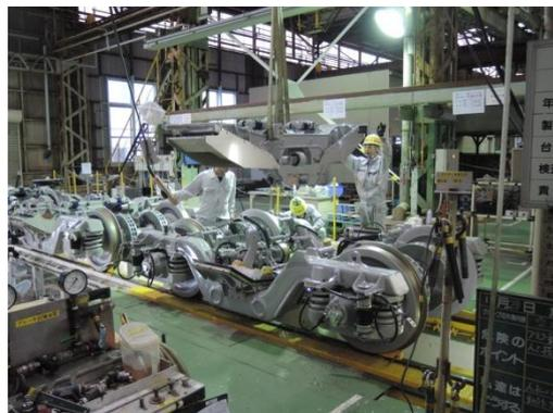
圖 3-65 傾斜樑與轉向架結合
