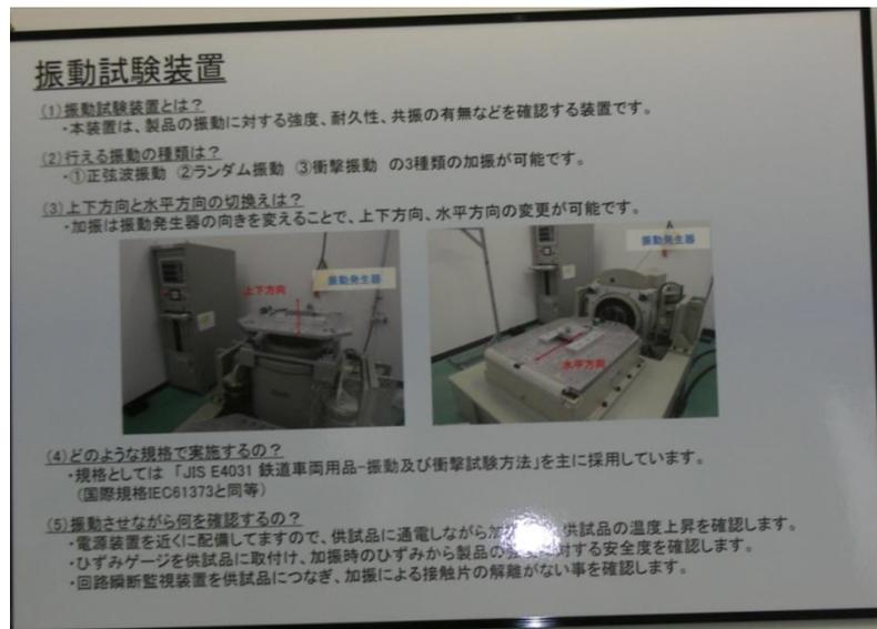
圖 3-21 振動試験装置説明
