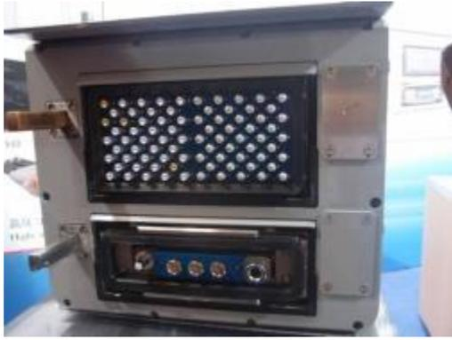
圖 5-15 雪地用電氣自動連結器
