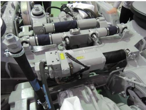
圖 3-70 傾斜抑制油壓避震器安裝
