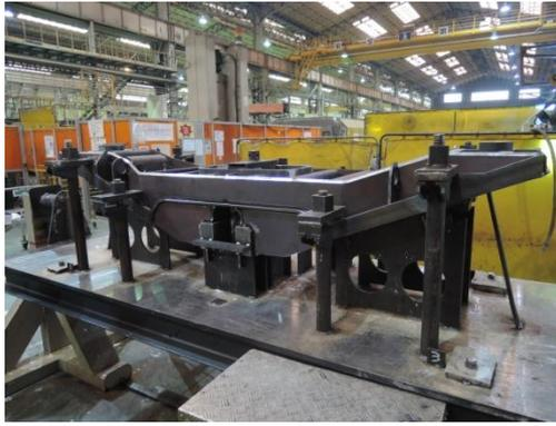
圖 3-60 傾斜樑焊接
