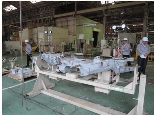
圖 3-63 傾斜樑保壓測試
