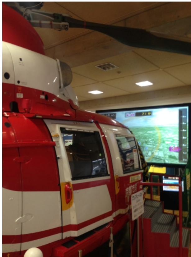
圖 6.以退役的直昇機改裝成虛擬實境體驗機，供民眾操作
