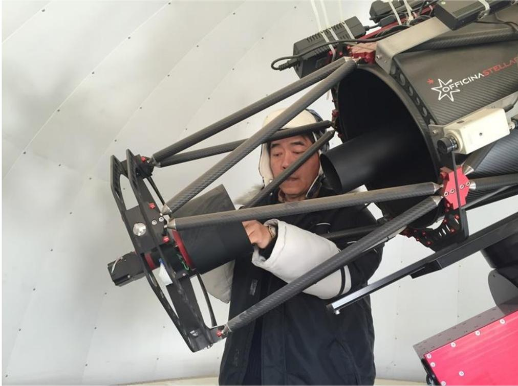
圖七：敝人以清水及濕布擦拭次鏡鏡面，將原先的丙酮痕跡徹底清除。
