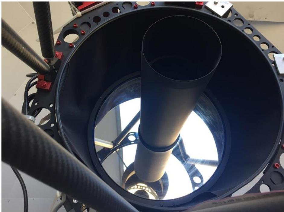
圖六：望遠鏡的鏡面以前在清潔時，以丙酮擦拭留下痕跡，這次我們用清水清洗。
