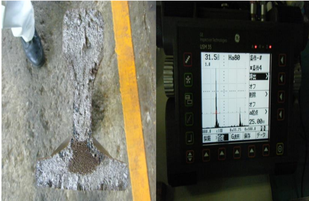
圖 柒-20 儀器判讀焊接不良等級
