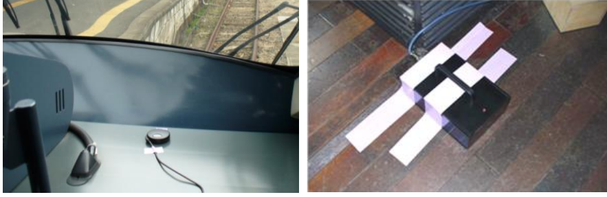
圖 陸-7 GPS Receiver 及 Compound Sensor 於駕駛室設置之位置
