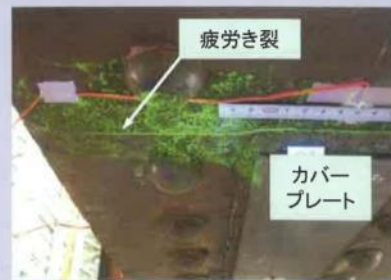
試験体から発生した疲労き裂
