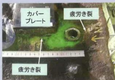
試験体から発生した疲労き裂
