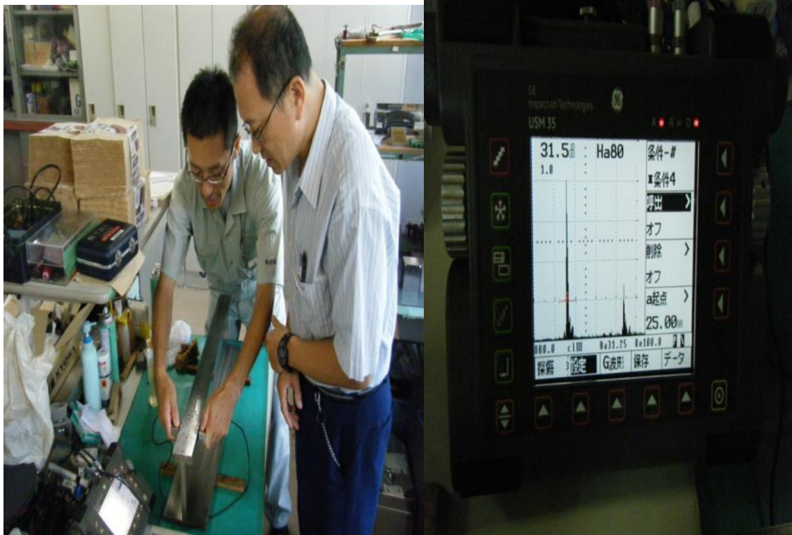
圖 柒-13 超音波檢測校準塊與檢測前校正
