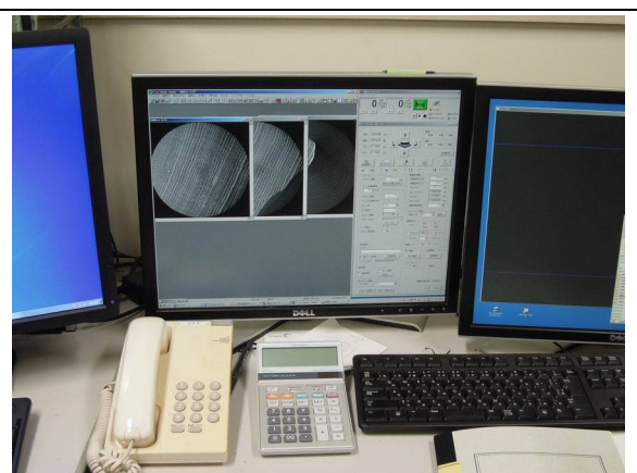
奈良國立文化財研究所 X 光顯微電腦斷層掃描影像系統及重建軟體介面
