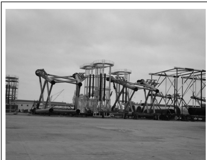
導管架及單樁基礎轉階段附屬設施
