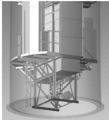
圖 4.5.2-6 離岸風電機艙塔筒底部除濕器保護
