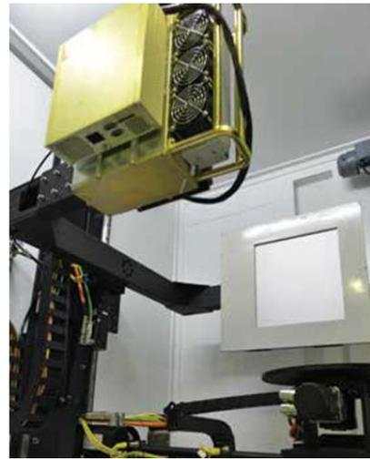
圖 29 型號 VJT C160/225 X 光造影儀內部 C-arm 機構
