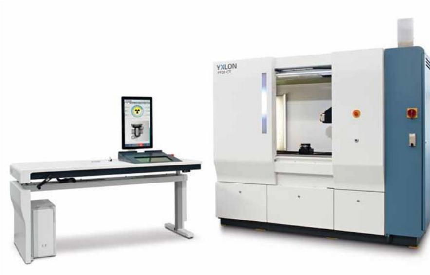
圖 27 YXLON *FF20 CT* 造影儀與操作台實照
