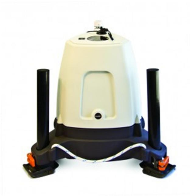
圖六 光達裝置 zephir 300（引用自 ZephIR Lidar 網站）
