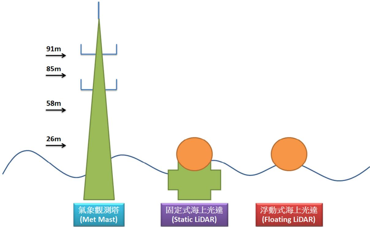
圖八 光達實驗裝置架設示意圖
