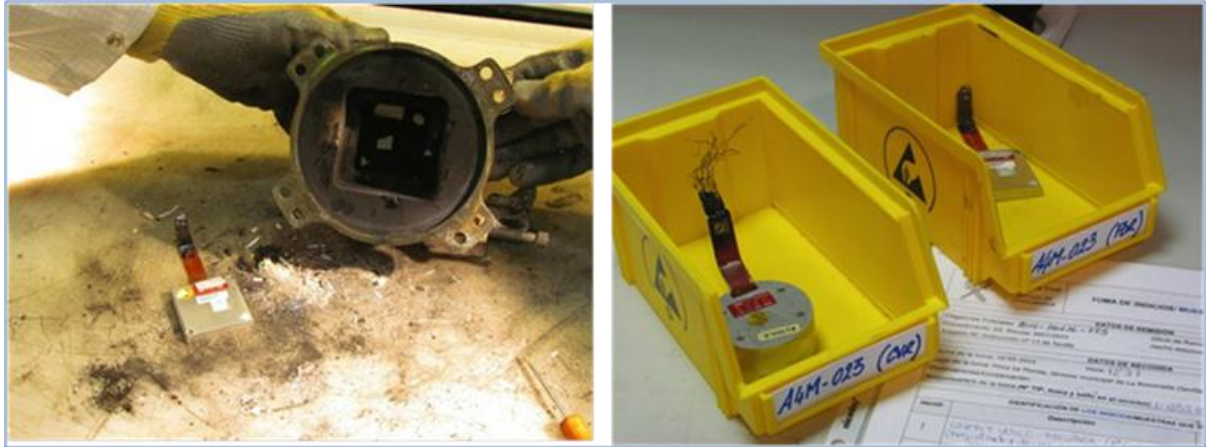
圖 10 (左) 損壞 L-3 FA2100 NAND 紀錄器取出的記憶體模組 (右) 左側的 FA2100 NOR 與右側的 FA 2100 NAND 記憶體模組外觀明顯不同
