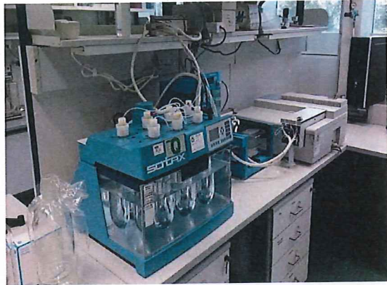
藥物溶離度檢驗儀器
