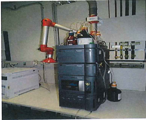
不法藥物檢驗儀器 UPLC/PDA Waters
