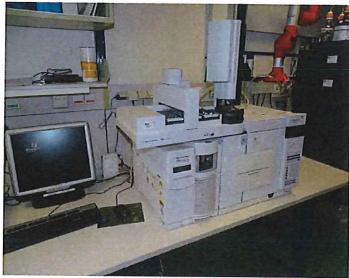
不法藥物檢驗儀器 GC/MSD Agilent
