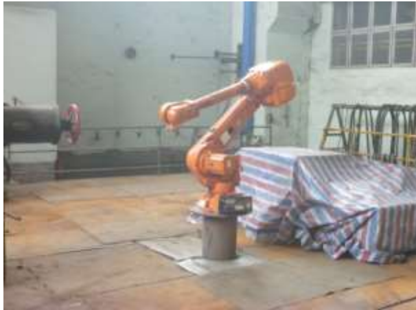
照片 7 碳化鎢高速噴塗之機器手臂與控制器
