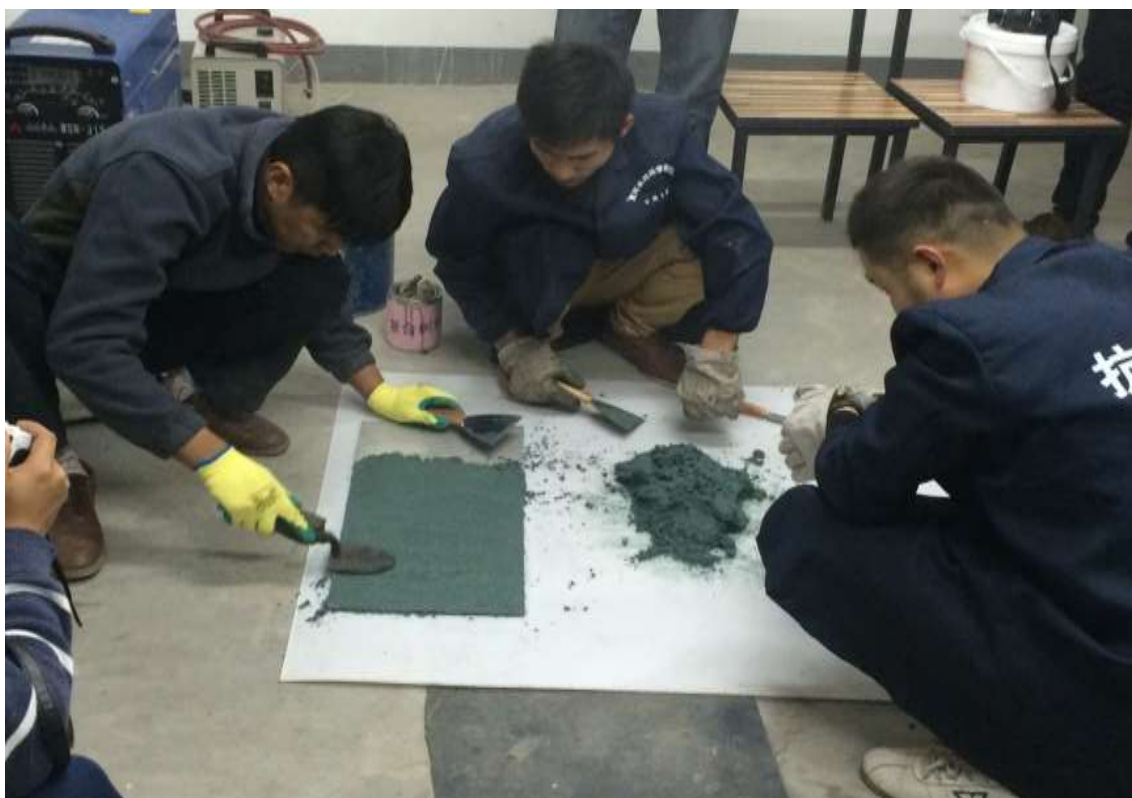
照片 3 黃科院抗磨材料試驗室現場示範環氧砂漿抗磨材料鋪塗情況
