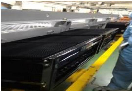
圖 3-3 動力系統散熱片組裝
