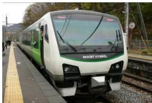
圖 4-32 油電混合車採用全自動連結器
