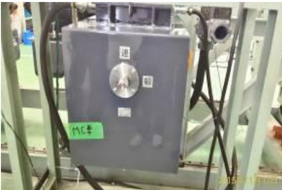
圖 5-13 全自動動連結器的自動(手動)解連控制部
