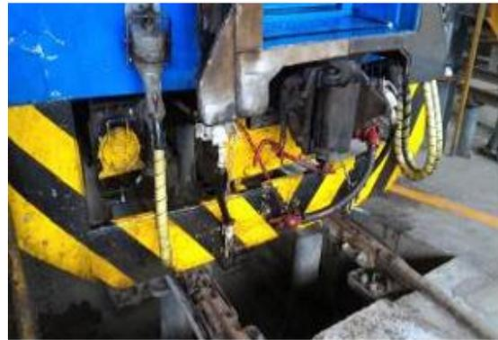
圖 5-10 台鐵 500 型連結器
