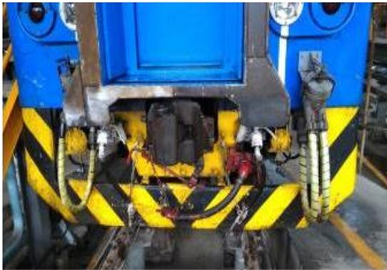
圖 5-9 台鐵 500 型連結器
