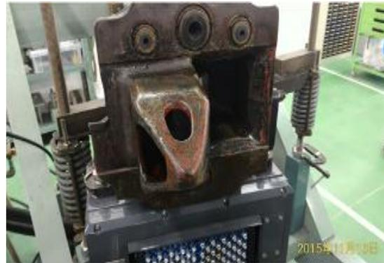
圖 5-14 全自動連結器的機械與 Air 對準連接部
