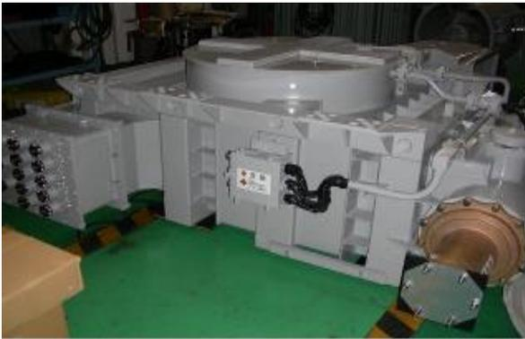
圖 3-9 變壓器外觀檢查
