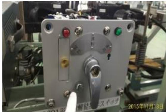
圖 5-12 全自動連結器的自動(手動)解連操作部
