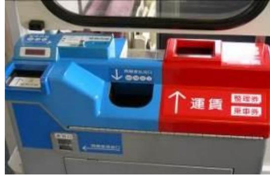
圖 4-22 車輛上可對換零錢的投幣機
