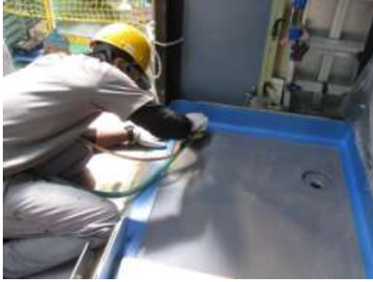
圖 3-75 車內地板研磨檢查
