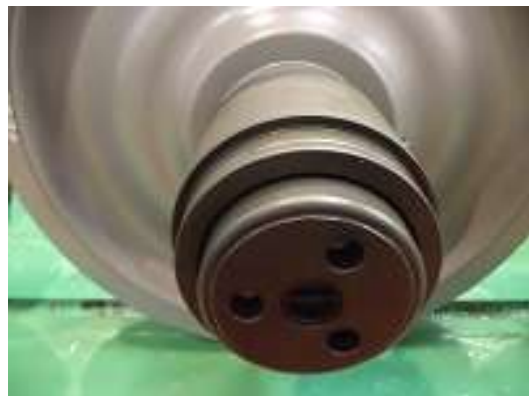
圖 3-25 轉向架車軸軸承檢查-2
