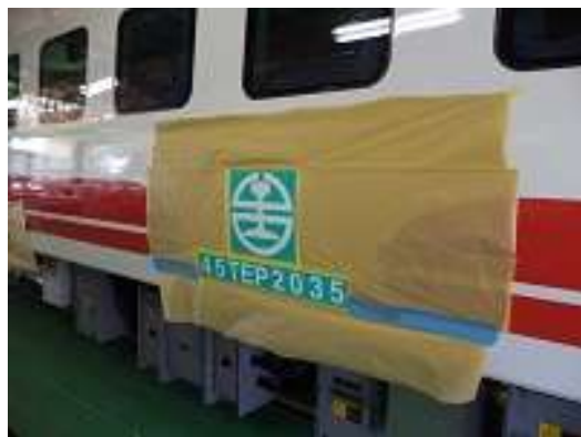
圖 3-103 標誌塗裝檢查-1
