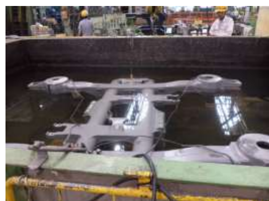
圖 3-10 檢視試驗槽是否有氣泡
