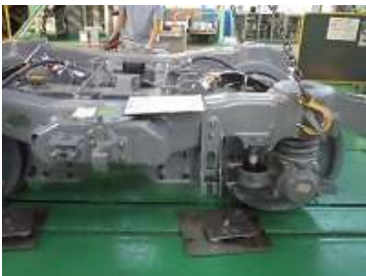
圖 3-41 轉向架與輪軸組裝-3
