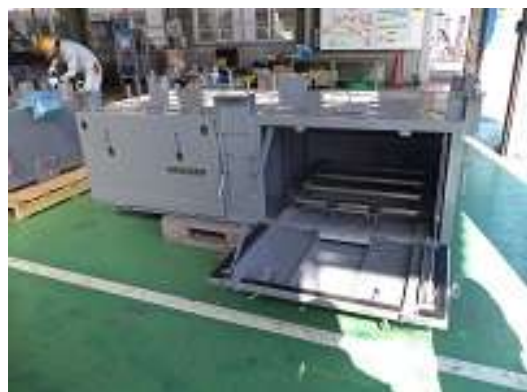
圖 3-94 電瓶箱安裝前檢查
