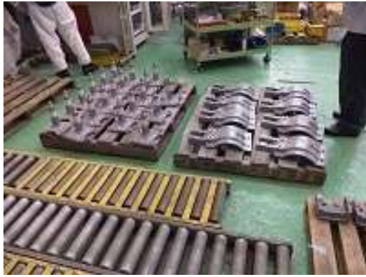
圖 3-27 軸箱下蓋及內筒檢查
