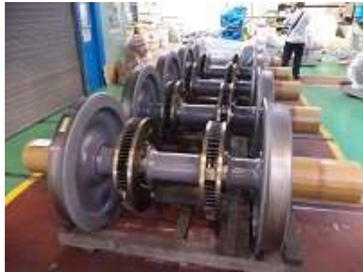
圖 3-23 T 車車輪組檢查
