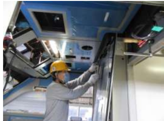
圖 3-82 駕駛室飾板安裝檢查
