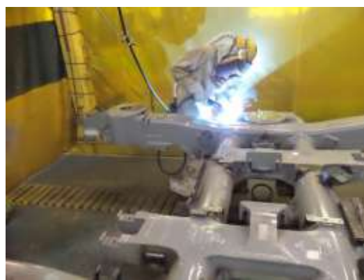
圖 3-12 轉向架管座銲接
