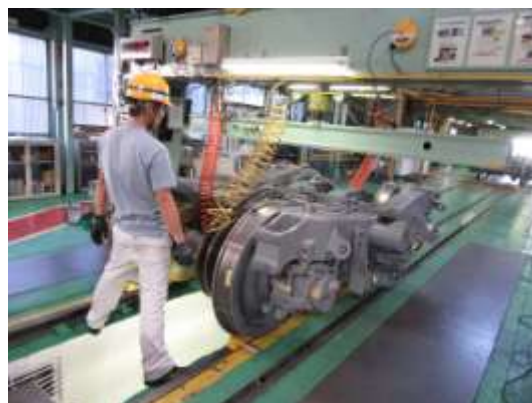
圖 5-13 軔機配管加壓
