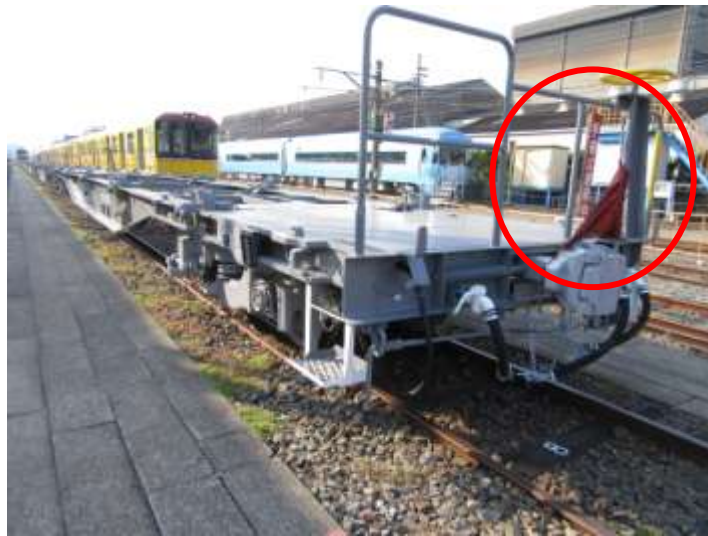
圖 4-7 禁動紅旗及手軔機鎖緊使用中警示牌
