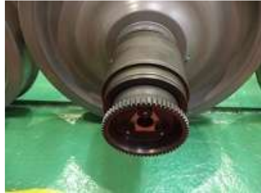
圖 3-24 轉向架車軸軸承檢查-1
