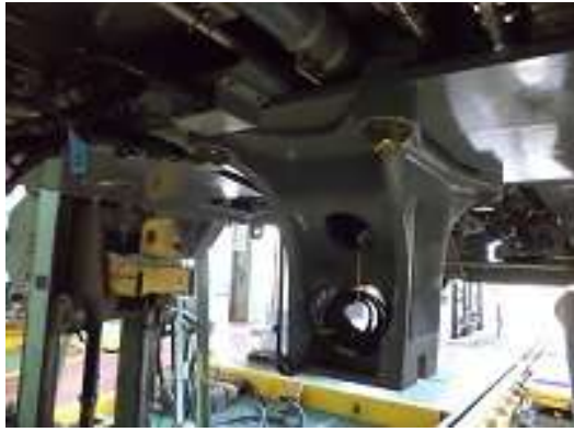
圖 3-99 車架中心插銷檢查
