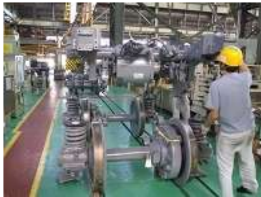
圖 3-39 轉向架與輪軸組裝-1
