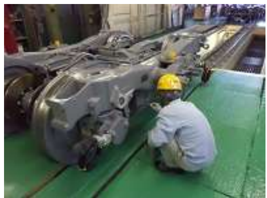
圖 3-58 荷重試驗完成塗裝
