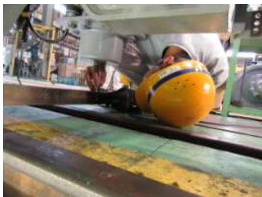
圖 5-20 APC 接收器尺寸測量
