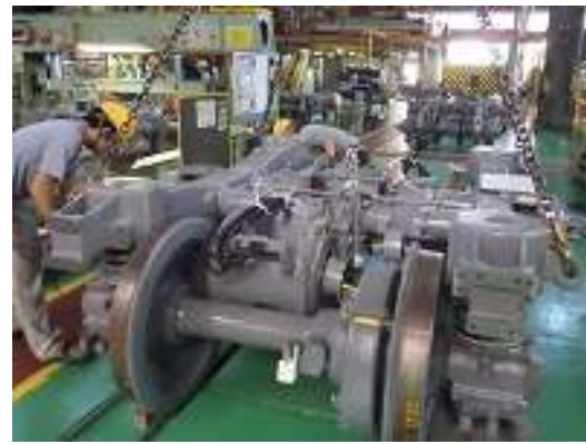
圖 3-40 轉向架與輪軸組裝-2
