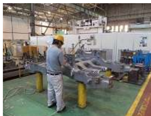
圖 3-14 機械加工去毛邊
