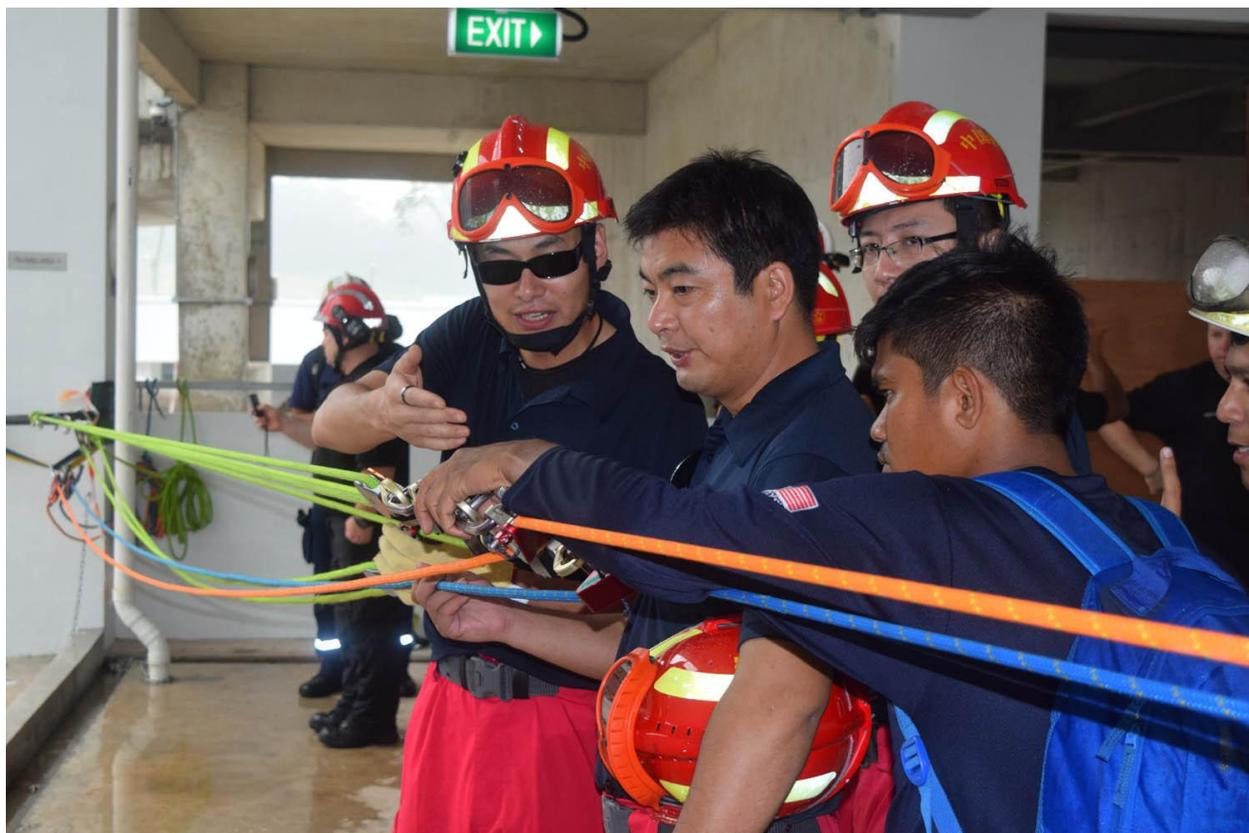
圖 9 運用拉力計實際測試分力系統數據(民防部隊提供)
