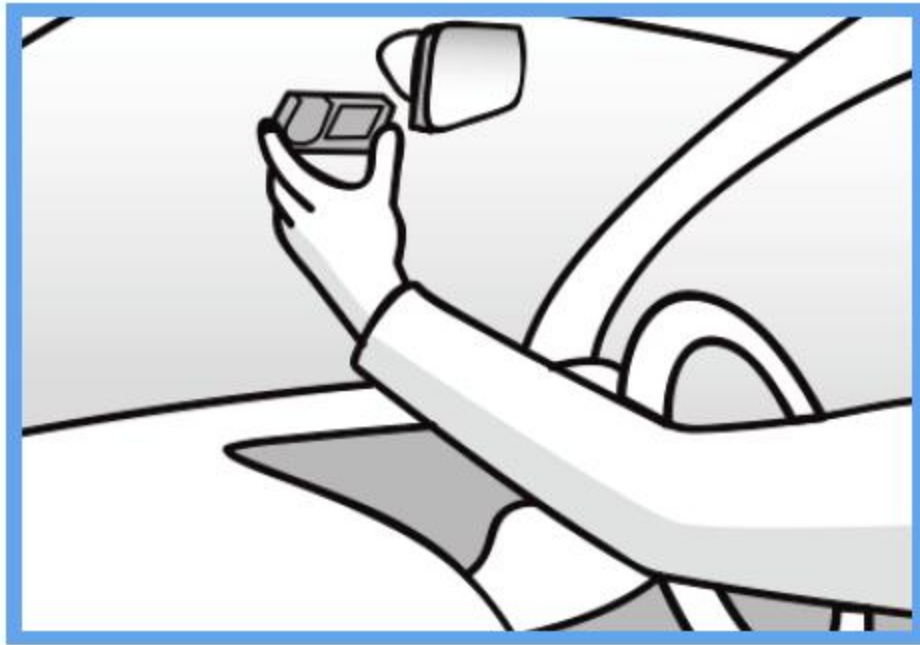
圖 29 愛爾蘭車上設備單元安裝示意圖
