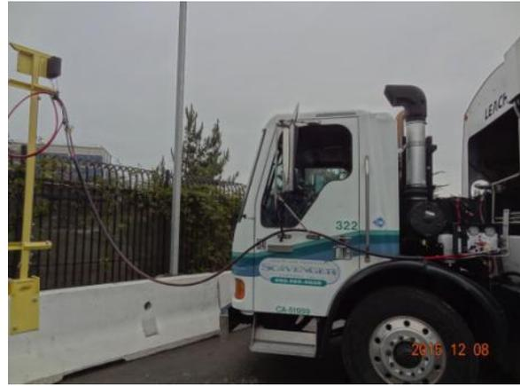
圖 47、加氣中的清運車，現場也有快速加氣設備，縮短給氣時間
