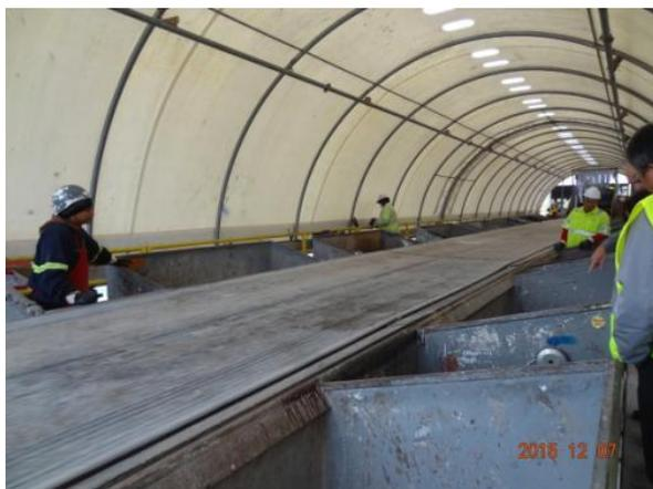
圖 55、人工初篩程序，以人工判視相關物料，投入至不同的管道中
