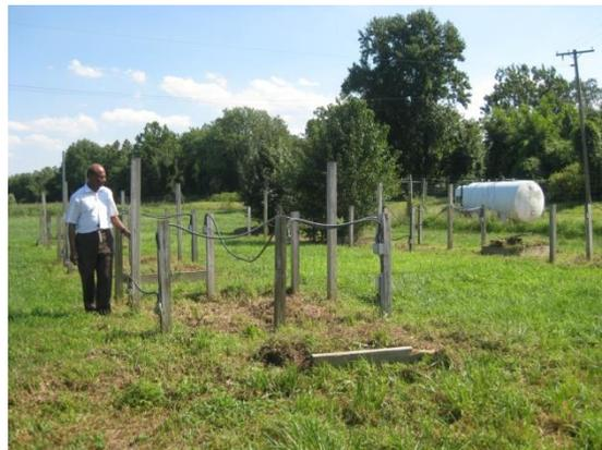
14. Open top chamber(玻璃板移除維護中)和 CO<sub>2</sub> 供應槽。
