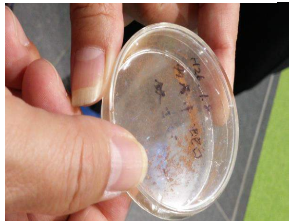
立川辦公室設有水質檢驗室對水質異常問題進行檢測（圖為水龍頭因鏽蝕而殘留的鐵屑）
