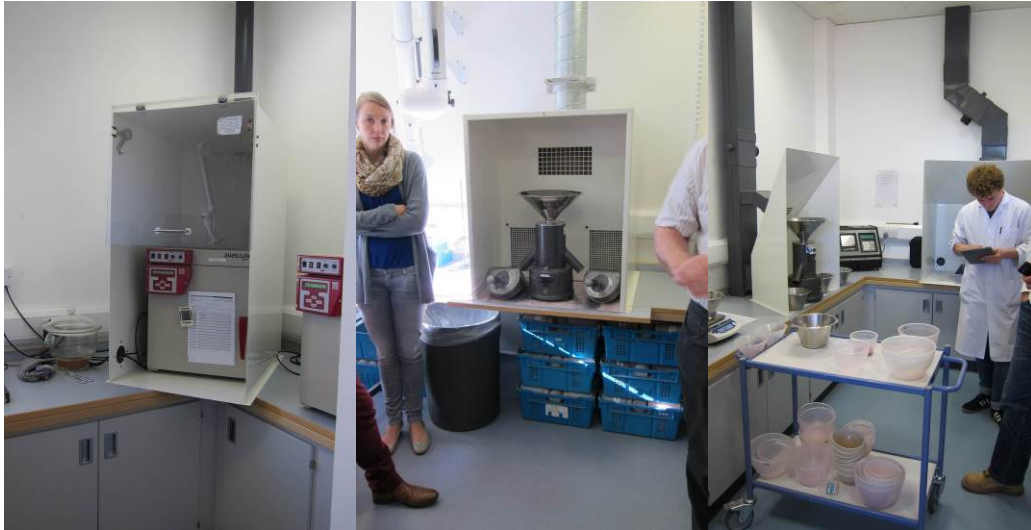
圖 18. 實驗室參觀。分樣及水分測定實驗室：左圖為烘箱；中圖為自動分樣器，儀器上方具有抽風設備，避免分樣造成的飛塵影響實驗室清潔；右圖為檢測人員正在利用平板電腦記錄檢測數據。
