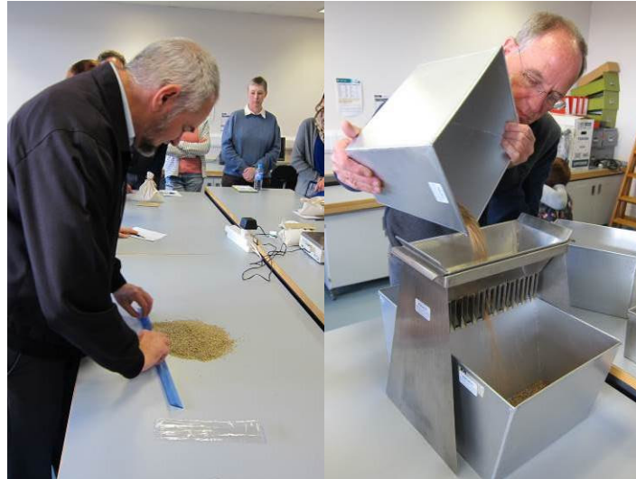
圖 10. 研習情形。分樣校正練習：左圖為 Mr. Eddie Goldschagg 講授手動分樣 (Hand halving method) 操作方法；右圖為 Mr. Max Soepboer 示範土壤分樣器操作方式。
