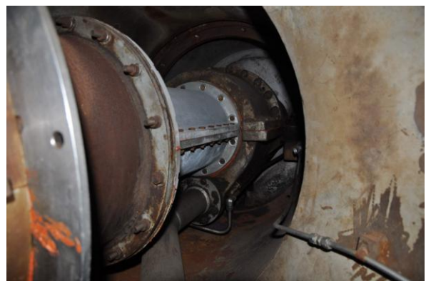
潤滑油系統需更換新油，並進行油洗作業，軸承盡可能開蓋檢查
