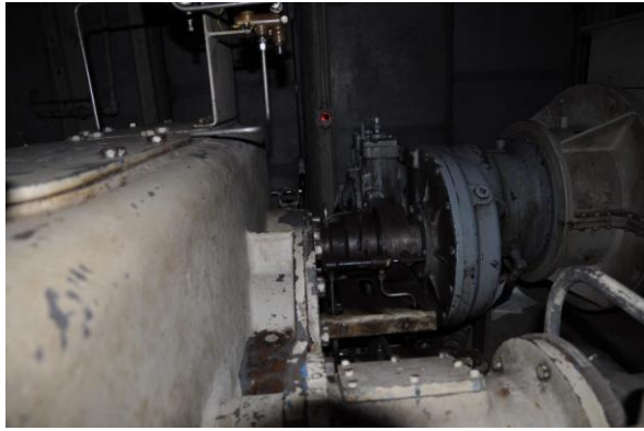
起動齒輪箱應打開檢查並清理油垢
