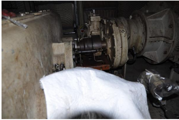
起動齒輪箱應打開檢查並清理油垢
