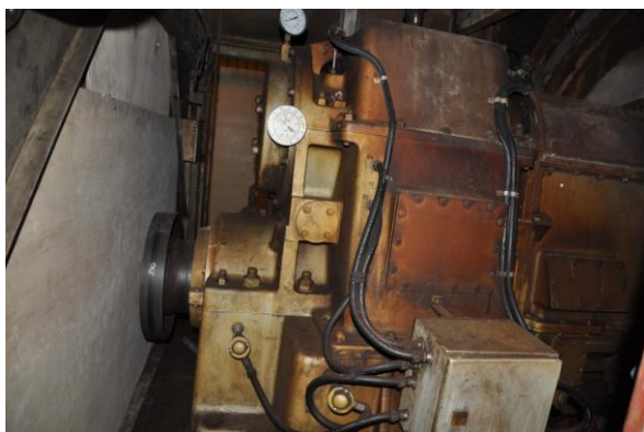
減速齒輪箱需拆蓋清理及檢查齒輪
