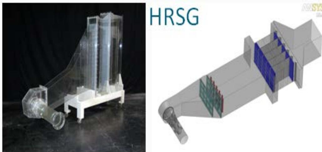
圖 4. NELS 的物理與 CFD 典型建模-HRSG
