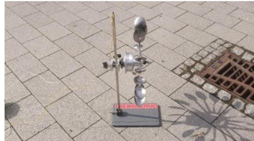
圖 6 自製之體驗水力發電的教具
