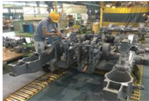
圖 2-38 框架安裝碟式軋機主體
