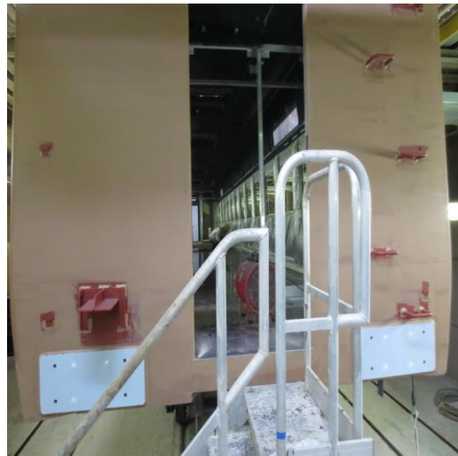
圖 2-56 車體外觀批土、拋磨、整平-2
