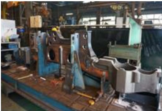
圖 2-25 組合側樑部品 B+軸箱圈簧座
