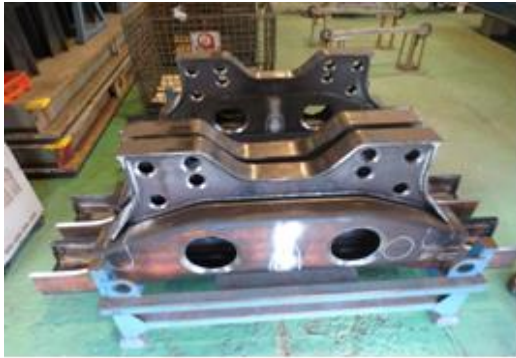
圖 2-23 鑽銑軋機托架安螺座及倒角
