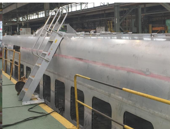
圖 2-45 各焊道之滲透性探傷檢驗-2
