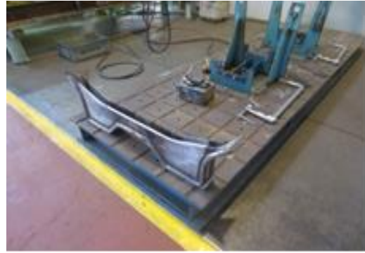
圖 2-18 軋機托架待與側樑部品組合
