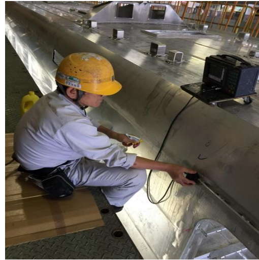
圖 2-48 超音波探傷檢驗-2
