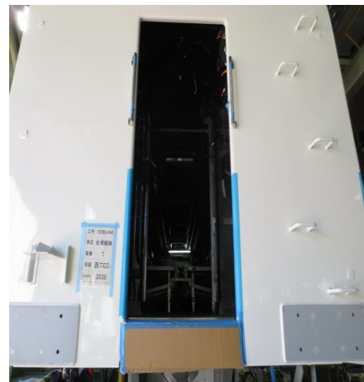
圖 2-58 車體外觀塗裝及噴漆作業-2
