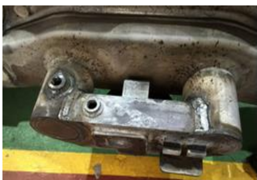
圖 2-31 焊接密封橫樑端口
