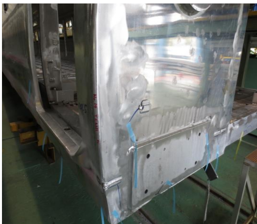
圖 2-42 焊道凹陷補焊及整修磨平-1
