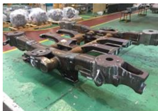
圖 2-32 框架主體待其他試驗及加工
