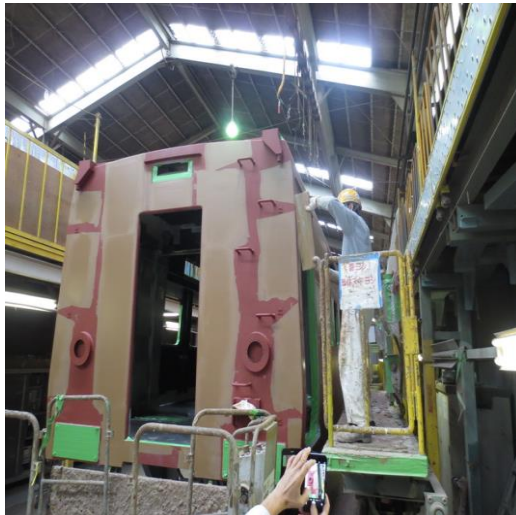
圖 2-55 車體外觀批土、拋磨、整平-1
