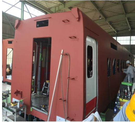
圖 2-54 車體通道門及上下車門試裝-2
