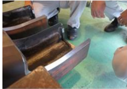
圖 2-24 側樑部品 B 待與圈簧座組合
