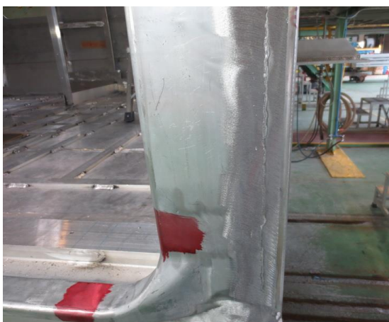
圖 2-44 各焊道之滲透性探傷檢驗-1
