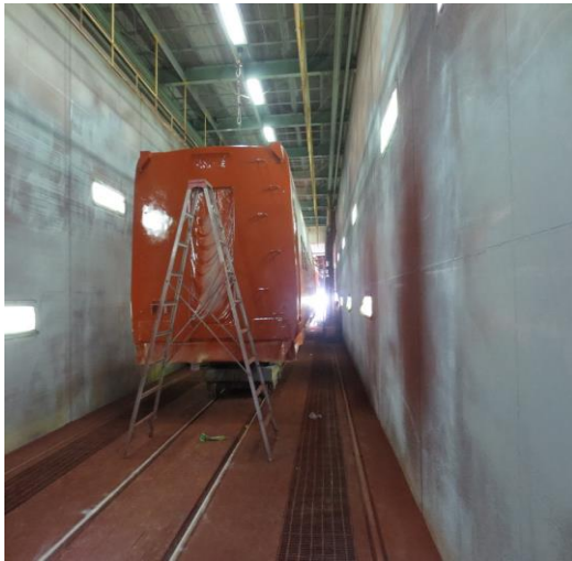
圖 2-49 車體塗裝作業-噴底漆-1
