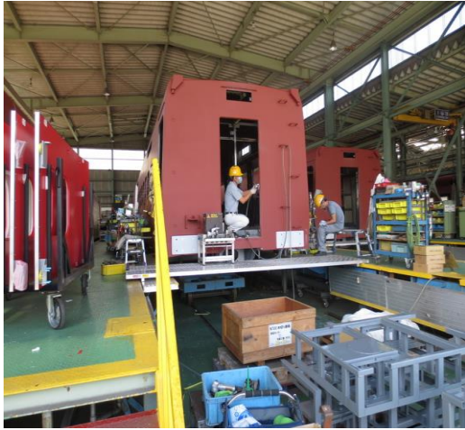
圖 2-53 車體通道門及上下車門試裝-1
