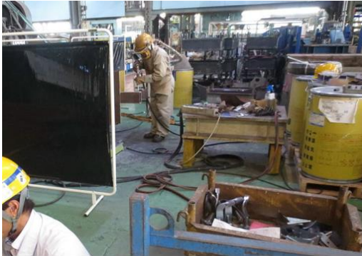
圖 2-17 片狀鋼材於製具上預焊組立
