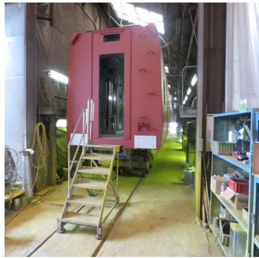
圖 2-50 車體塗裝作業-噴底漆-2
