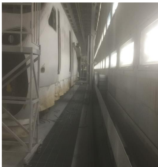
圖 2-57 車體外觀塗裝及噴漆作業-1
