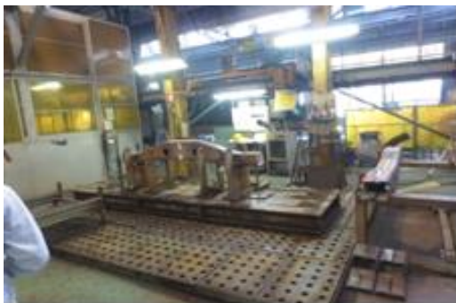
圖 2-21 側樑部品 A 待與軋機托架組合
