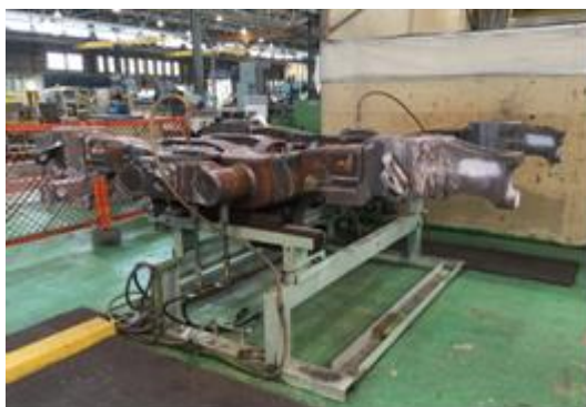
圖 2-33 框架主體水氣密試驗
