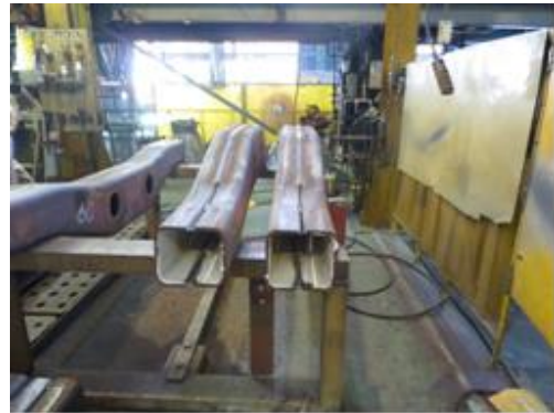
圖 2-20 II形鋼材預焊成□形側樑
