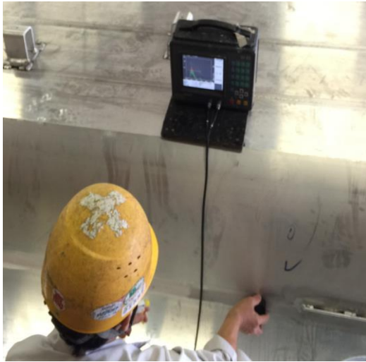
圖 2-47 超音波探傷檢驗-1
