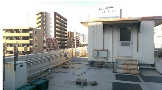
一般測站。備有 SPM、SO<sub>2</sub>、NO<sub>x</sub>、O<sub>3</sub>、NMHC、THC、SPM 與 PM<sub>2.5</sub> 等自動監測設備及風向、風速、溫度、雨量等氣象設施。日本空品監測主要分為一般大氣與自動車排氣(交通)站，監測作業並未制定繁雜的品保品管作業系統，其品管作業主要採儀器源頭管制與人員管理，即藉由儀器合格驗證與計量人員資格認證制度確保測站操作運轉品質，計量人員為計量檢定工作的主體，在計量檢定工作中發揮主導效用，並定期保持穩定
