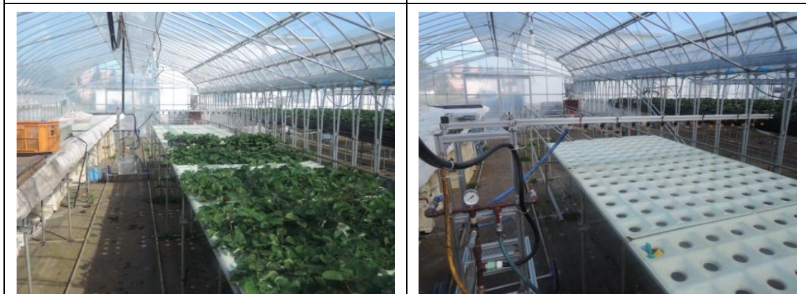
圖 27：佐藤博士設計的熱水處理機於溫室內進行實際的病蟲害防治測試
