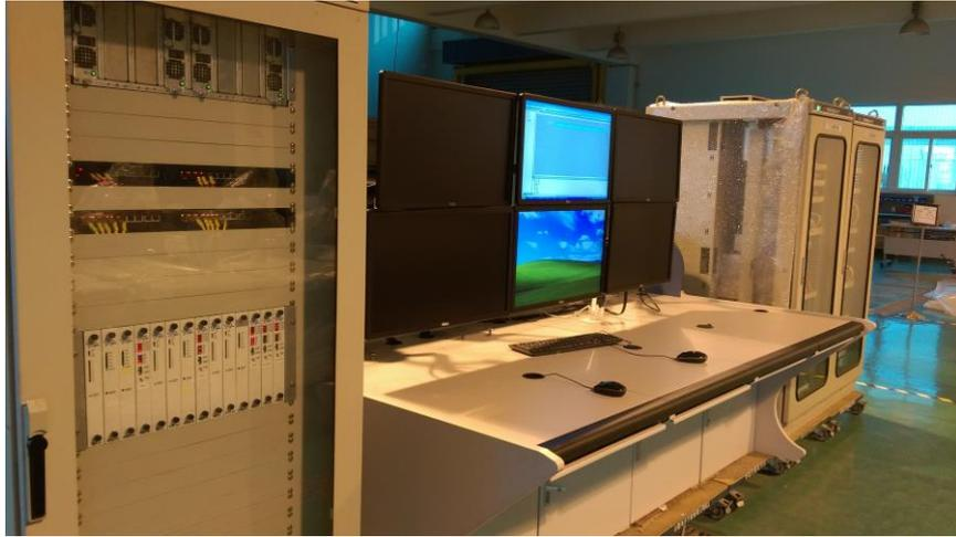
圖 8. 整合性控制與安全系統展示平台
