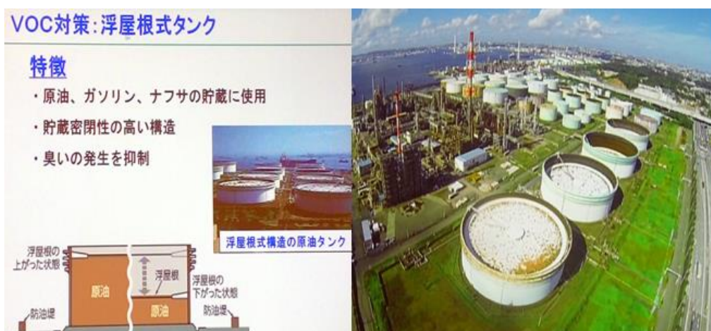
圖 2：浮頂式儲槽示意圖
