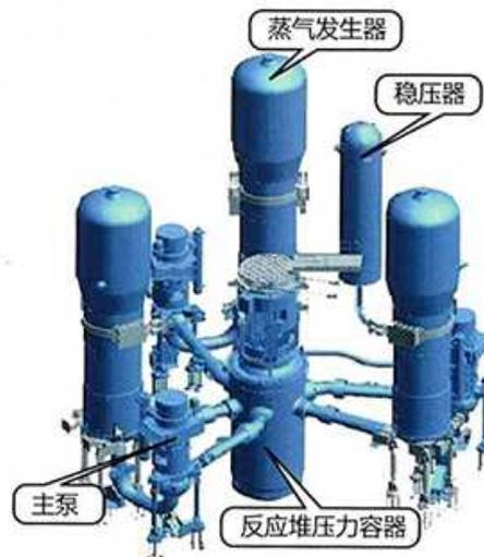
第二道安全屏障：反应堆压力容器和一回路压力边界
