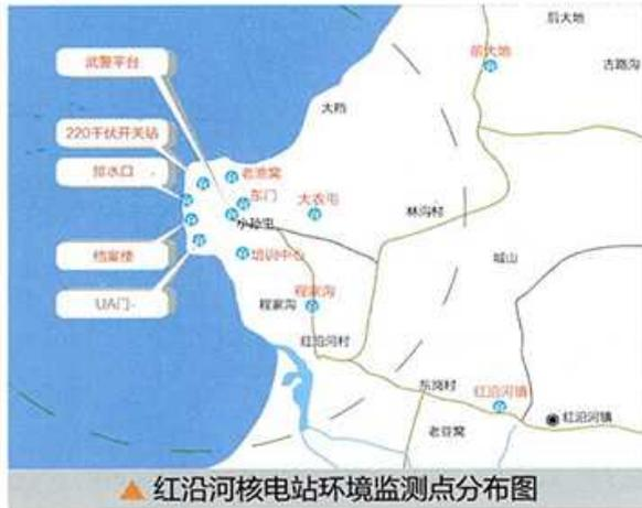
核裂变产生的放射性被限制在一回路内，用于冷却机组的海水属于三回路，不与一回路直接接触，不带有放射性。红沿河核电站在厂区内、外设立了12个环境监测点，对厂区周边空气、水质、土壤等进行实时、严格监测。国家环保部门在厂区外建立了独立的环境监测网点，实施独立监督，及时向社会报告
