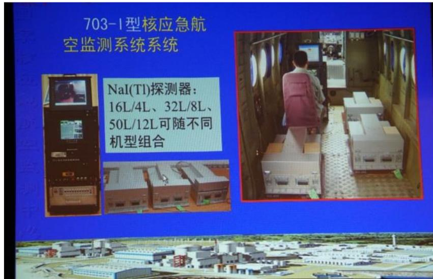
圖 16 陸方空中輻射偵測系統可隨飛行載具空間有不同偵測設備
