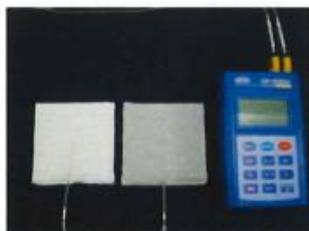
在試樣內放入熱電偶溫度傳感器做成試驗樣本
