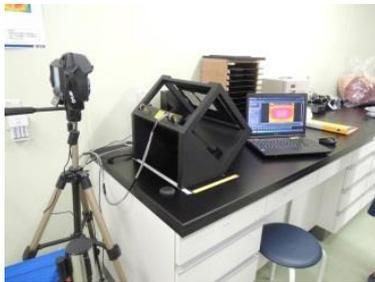
圖五、「再輻射特性」試驗裝置
