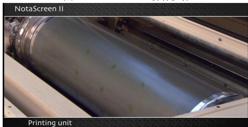
圖 14：Nota Screen II 印刷滾筒
