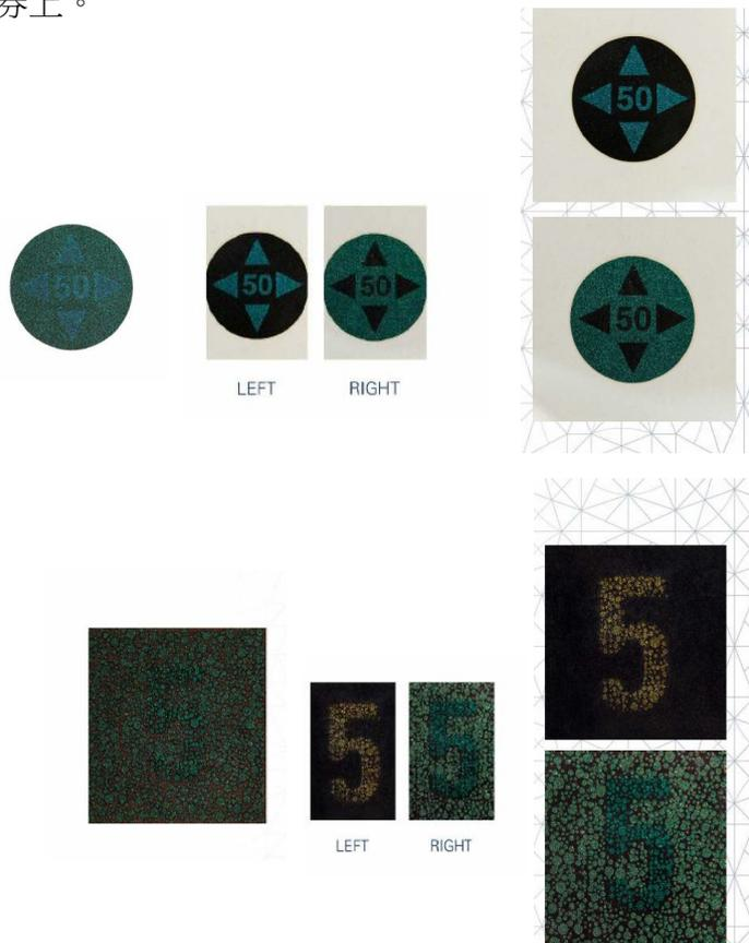
圖 10 膽固醇液晶的偏光性質
