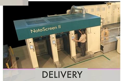
圖 29 網版印刷機
