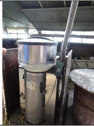
圖 14.小牛自動代乳品給飼機，當小牛進入感應欄時自動即時沖泡溫奶提供給小牛採食
