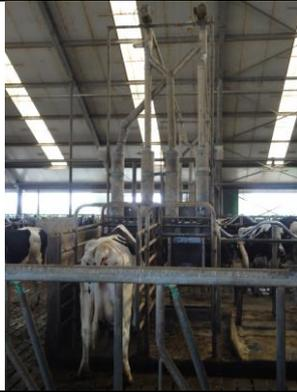
圖 7.自動精料給飼機，依照個別牛群需求，利用牛群頸部配掛之感測器辨識，提供牛群自由採食且符合需求的精料量
