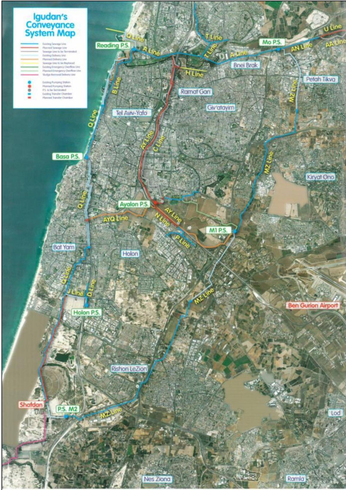
圖 3-5-1 Shafda 污水收集主要管線及泵站空拍圖(翻拍)
