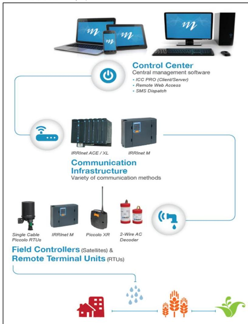
圖 4-3 IRRInet 系統整體架構圖
