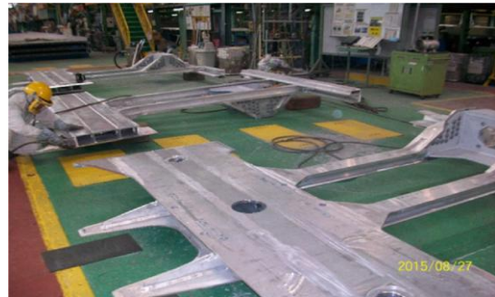
圖 3-3 車架框架組焊
