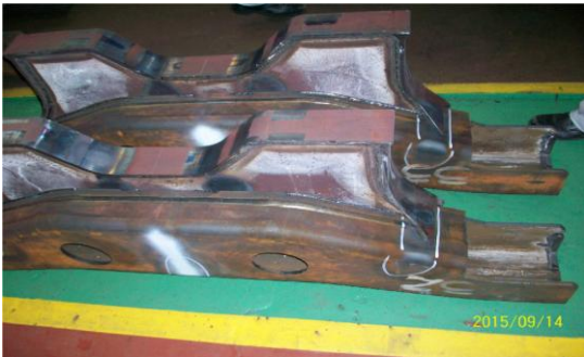
圖 3-46 外部零件焊接
