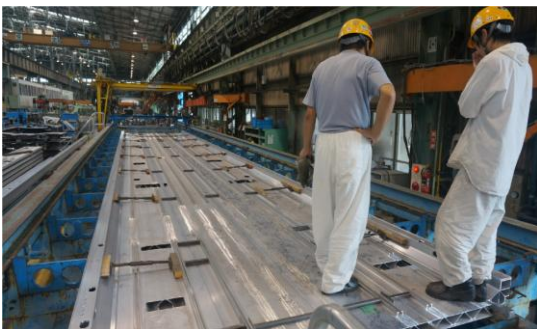
圖 3-4 車架地板及側樑組焊
