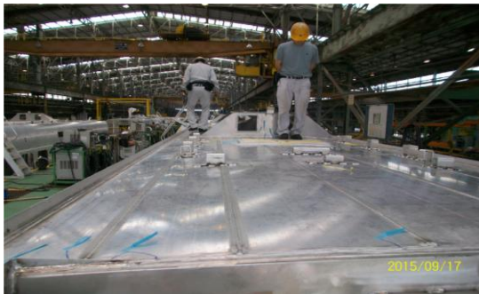
圖 3-23 檢查車頂有無變形 及發出變形回彈聲響
