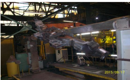
圖 3-48 外部零件焊接，使用 大型迴轉治具
