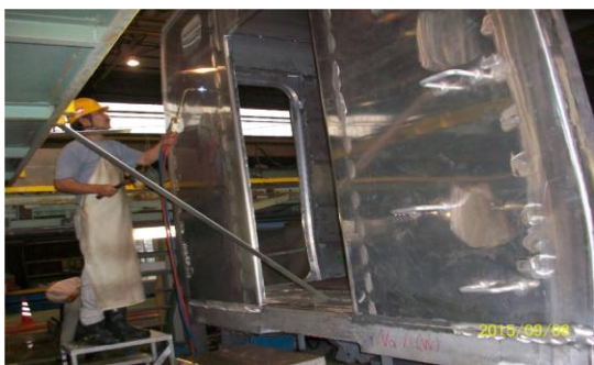
圖 3-36 加熱取直修正作業
