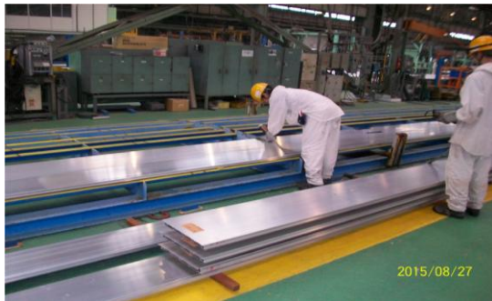
圖 3-24 將板材固定於治具上
