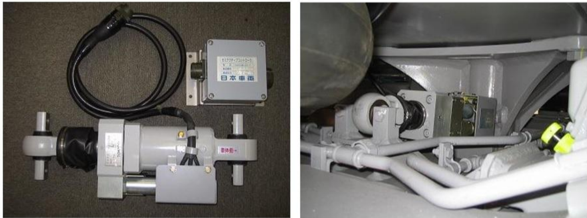
圖 5-2 半主動式油壓減震器上視圖(左)及車上安裝狀態(右)
