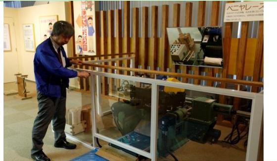
圖 91、合板薄片削皮之機具操作示範
