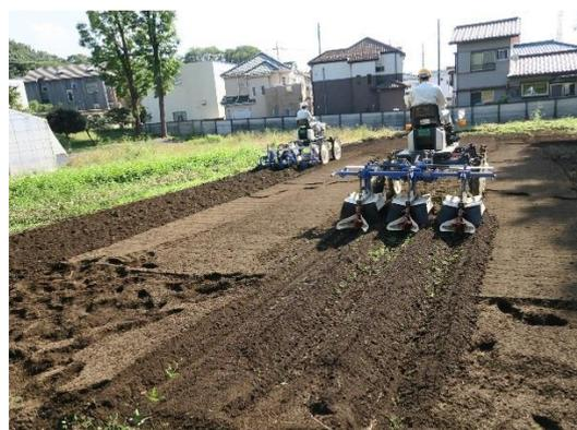
耕犁型及耕刀細碎型二種乘坐式除草機 作業速度與耕犁細緻程度的比較
