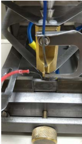
圖 9 試片點銲熱電偶:(a)進行熱電偶銲接; (b)熱電偶銲接完成後的試片形貌。
