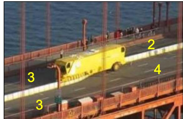
圖 2.2.3.2-8 金門大橋車道調撥－機械式自動化移動護(隔)欄作業
