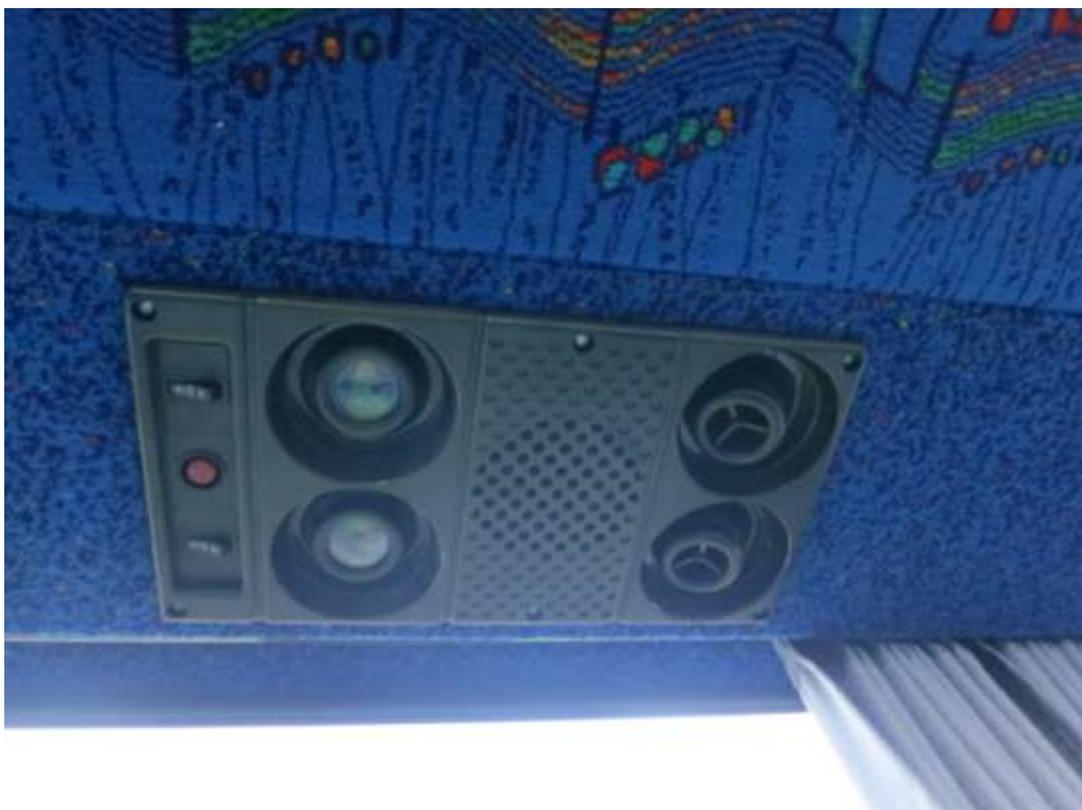
圖 B-2 5 星級遊覽車照片(個人式空調出風口及調控板&個人閱讀燈&喇叭)
