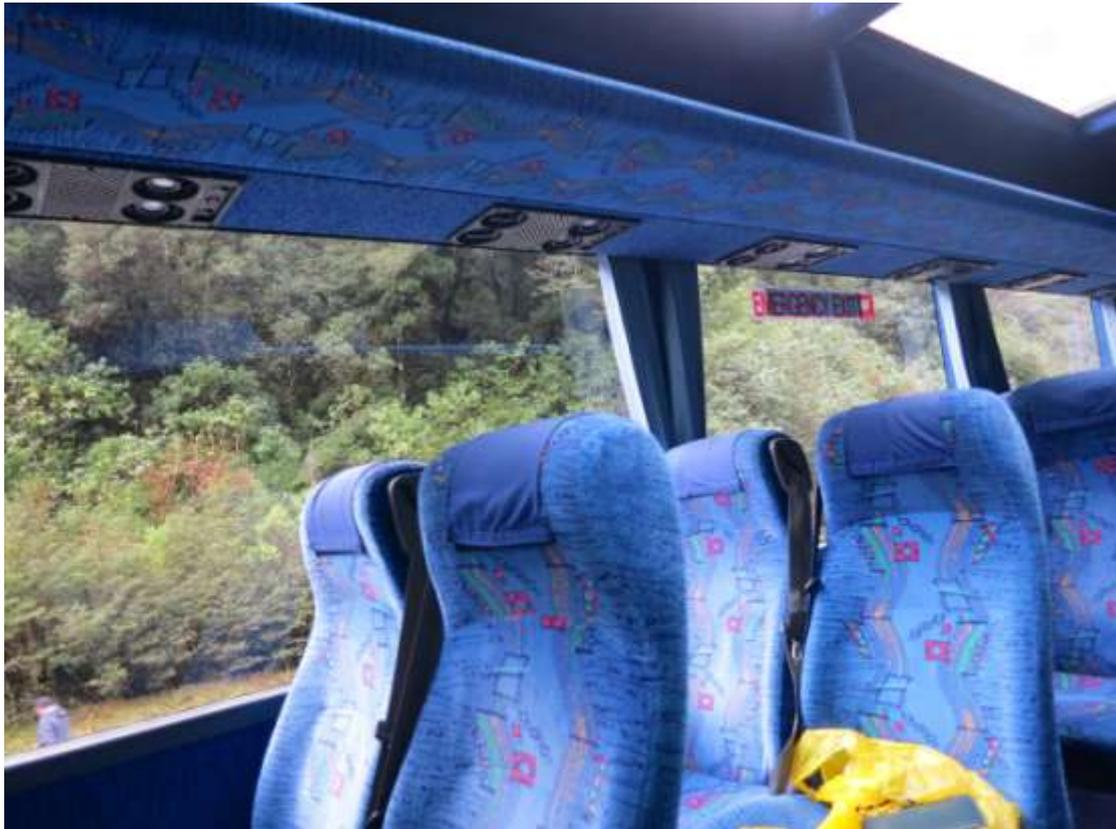
圖 B-19 4+星級遊覽車照片(個人式空調出風口及調控板&個人閱讀燈&喇叭)
