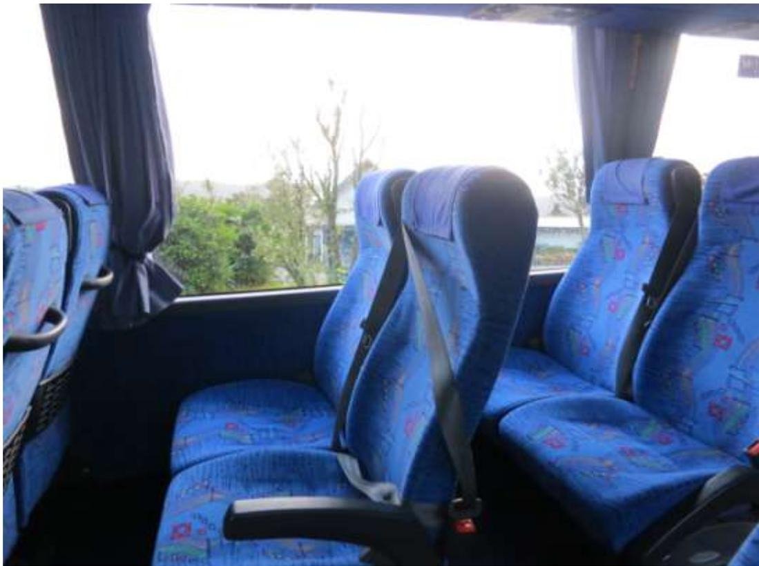
圖 B-6 5 星級遊覽車照片(車窗窗簾&三點固定式安全帶)
