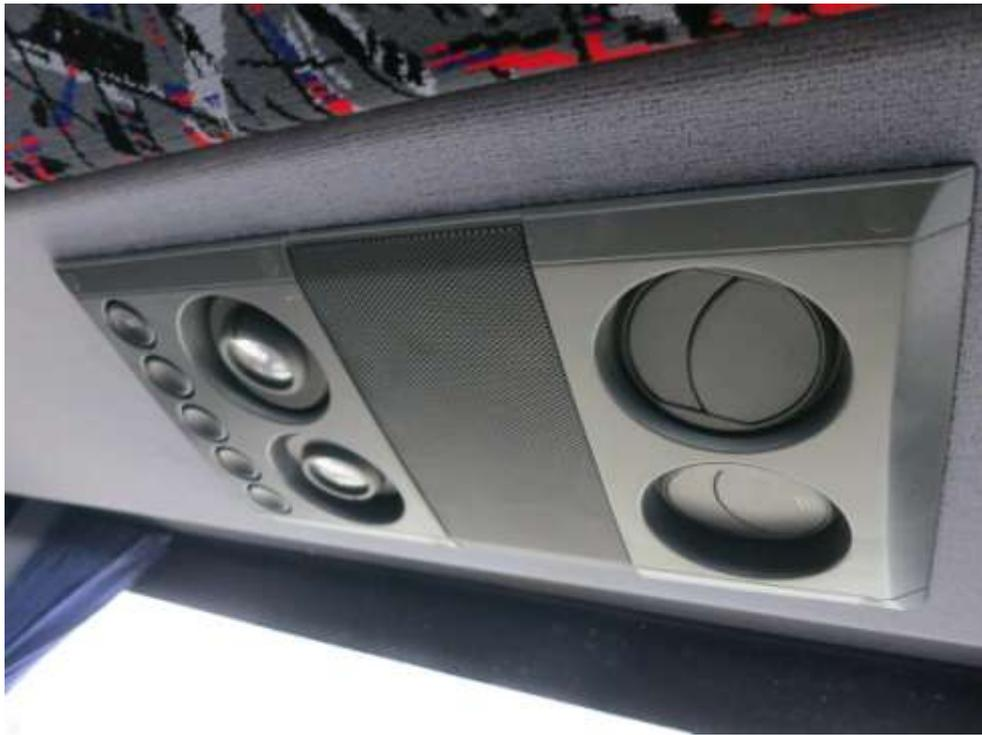
圖 B-25 4 星級遊覽車照片(個人式空調出風口及調控板&個人閱讀燈&喇叭)
