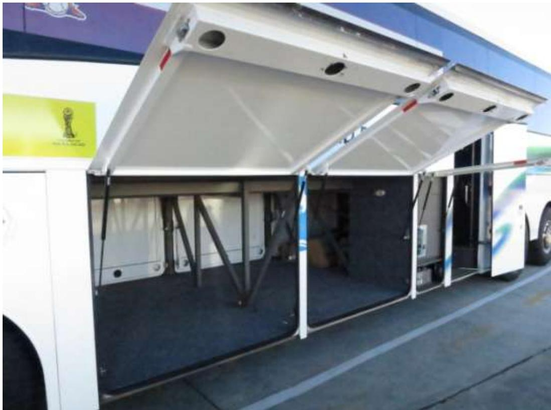
圖 B-8 5 星級遊覽車照片(有保護襯裡之行李廂)
