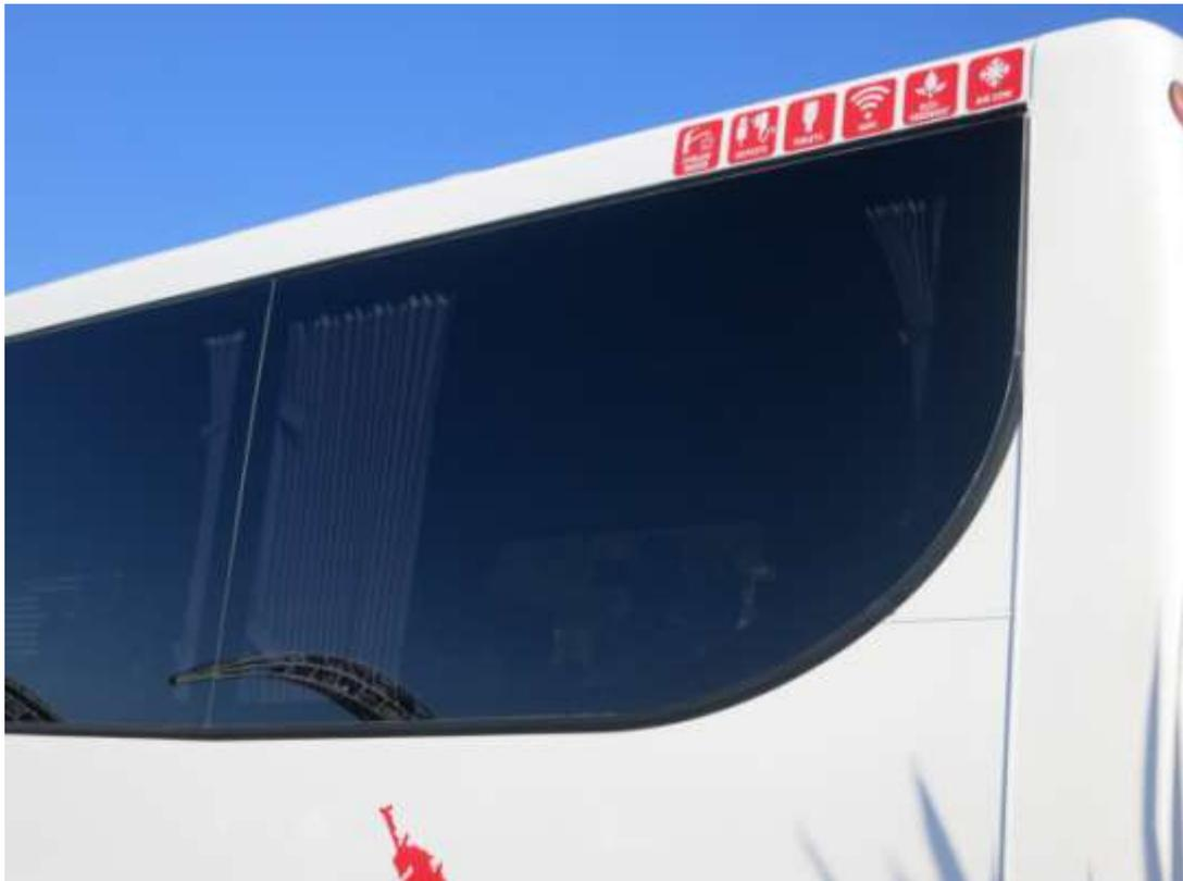
圖 B-7 5 星級遊覽車照片(防曬膜觀景窗&一片式固定玻璃窗)
