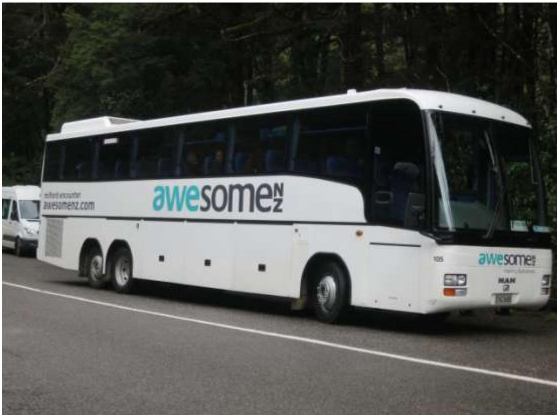
圖 B-20 4+星級遊覽車照片(防曬膜觀景窗&一片式固定玻璃窗)
