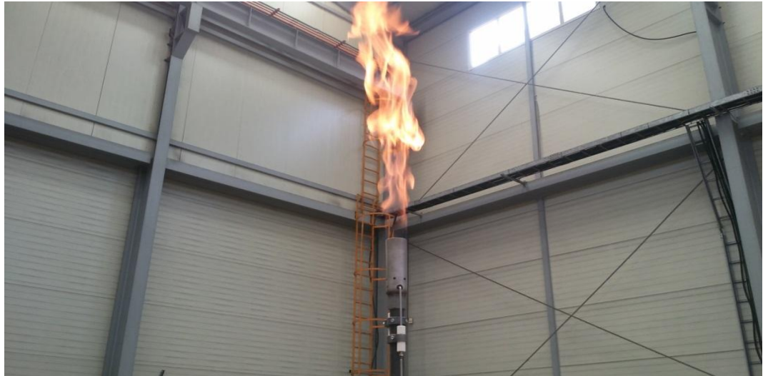
圖十三、測試中Burner的燃燒狀況
