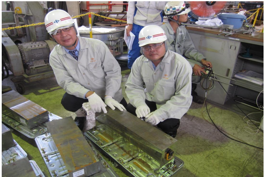
D.R-3000的TOFD UT 現場實地抽驗檢測，抽驗JC3 a圖二十七、.試片:先測試是否能將缺陷檢測出來
