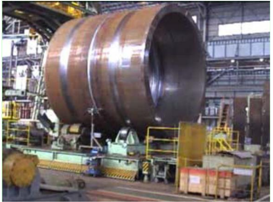
圖二十六、在現場做TOFD UT檢測R-3000鋁道JC3以確認品質
