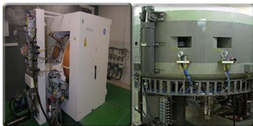
圖 35、峨山醫學中心迴旋加速器（左圖為 PETtrace-GE；右圖為 IBA-Cyclone18/9）
