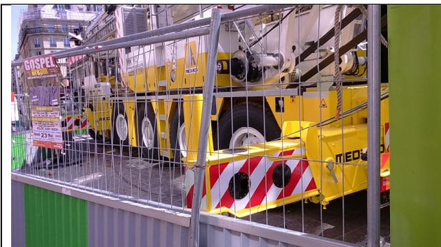
圖 7 移動式起重機路邊停放時，以圍籬作適當人員隔離及防護
