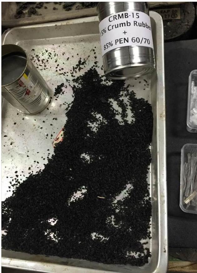
實驗室正在進行利用輪胎屑當成鋪面材料的實驗，據介紹人員說明，目前成果相當不錯，在硬度上有一定的水準，未來車輛的運行上，也可以降低噪音值。他們正試著增加輪胎屑在整個材料上的比率。
