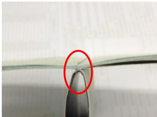
圖 14 消除車縫線與晶片封皮間常見的孔洞（瑕疵）
