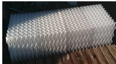
散堆填料：使淋落海水在其表面形成液膜分佈增大海水吸收煙氣的面積，材料為聚丙烯(Polypropylene)，高度 3.25m。
