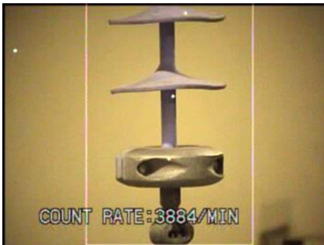
圖 10 加壓於有均壓環之新的礙子之紫外線放電影像
