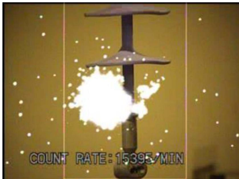
圖 6 加壓於新的礙子且沒有均壓環之紫外線放電影像
