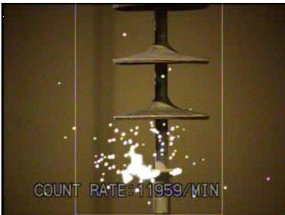
圖 15 加壓於無均壓環的老化礙子之紫外線放電影像
