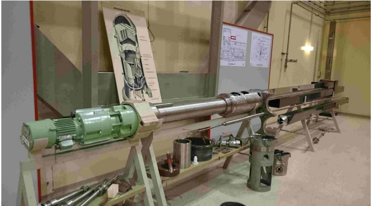
圖(8)控制棒葉片與燃料組件
