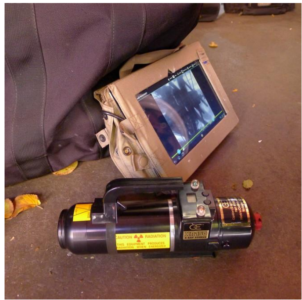
圖 5 小型 X 光掃描器，並於包包後放置鋼板(林曉如拍攝)圖 6 小型 X 光掃描器所呈現的影像 (林曉如拍攝)
