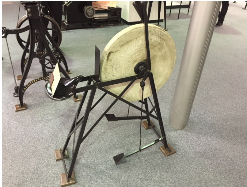
圖 2-1 約 1860 年代生產的足踏式研磨機。
