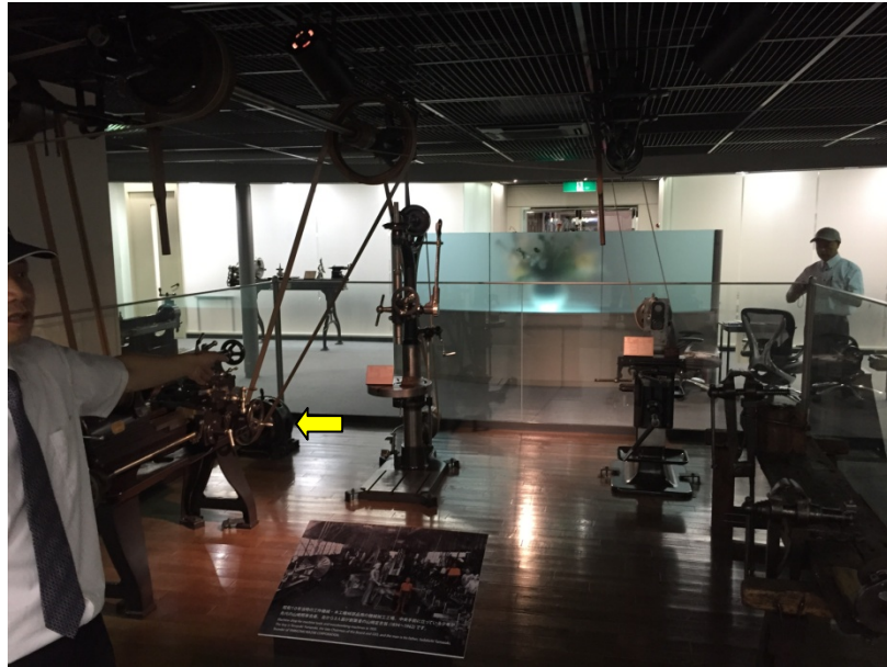
圖 2-3 集中式動力源(如箭頭)與各式工具機之動力連結。
